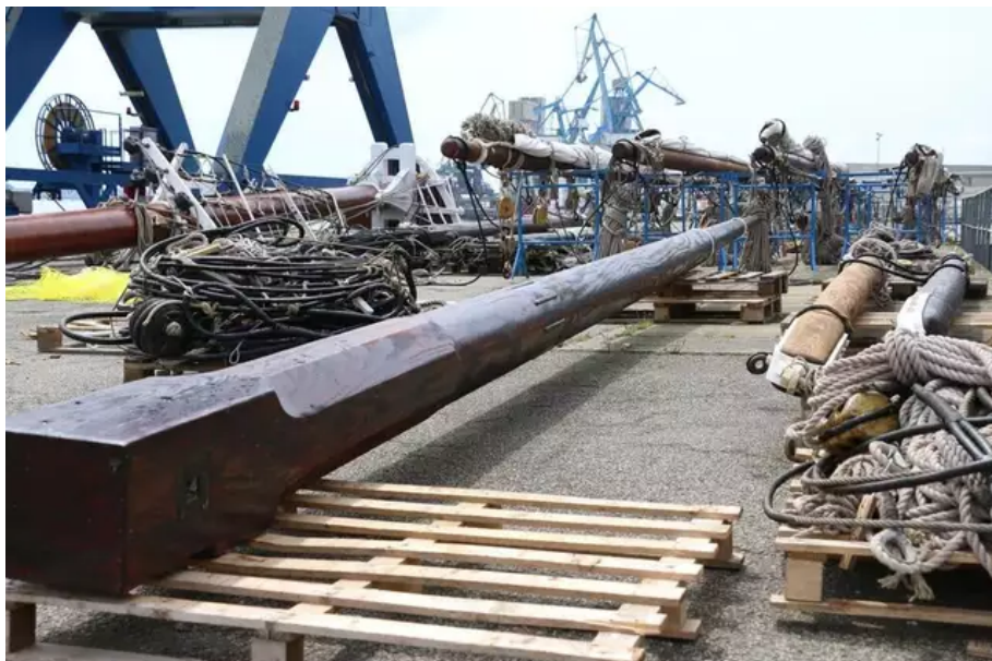
La mâture du « Français » a été refaite en grande partie, il faut la remonter. © Ouest-France
