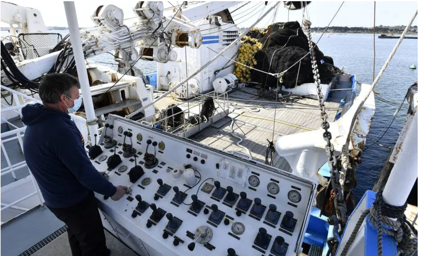
Le pupitre, duquel sont commandés les mâts de charge pour puiser le thon avec la salabarde (grande époussette) dans la senne (le filet) et la remonter et la ranger à l'arrière du bateau. | THIERRY CREUX / OUEST-FRANCE
