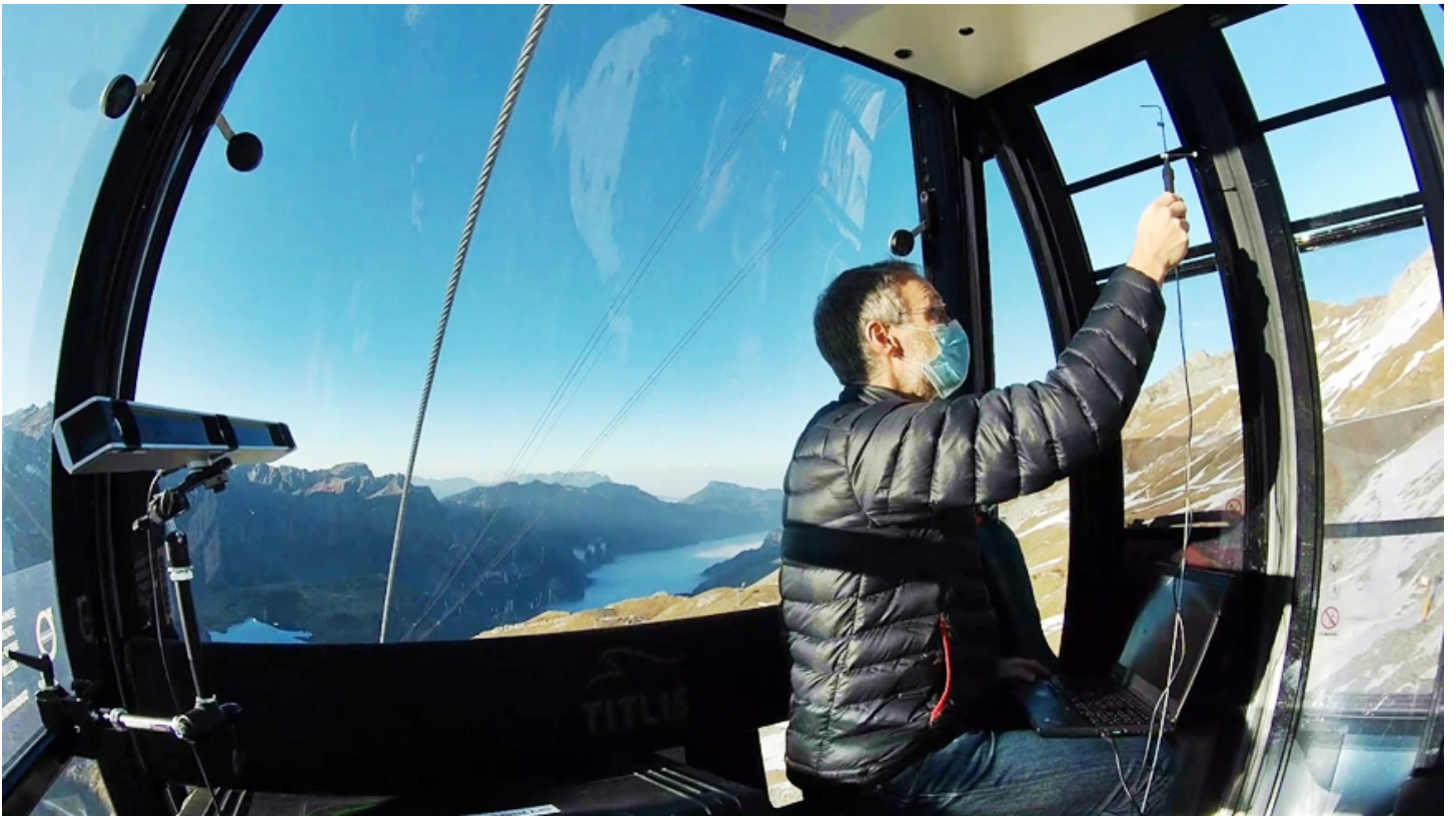
Les flux d'air dans la cabine : aux fenêtres, un spécialiste mesure les flux d'air à l'aide de capteurs de pression d'air. Image: Streamwise GmbH
